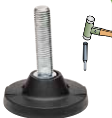
Réf. R0169 - Page R25 Ø 124 • Prêts à la fixation • Charge maxi 45000 N.
