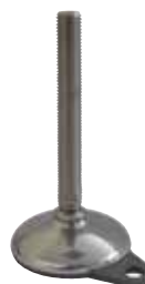
Réf. R0748F - Page R43 Ø 100 • Acier inox • Hygiène • Prédisposé au fixage • Charge maxi 25000 N.
