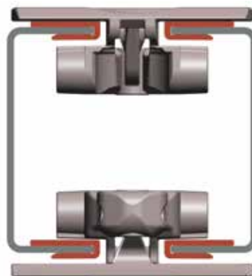
Largeur chaîne 82,5 mm (K 325) / Pas 85 mm
