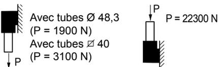
Les tests sont réalisés au couple de serrage: 2 Kgm
